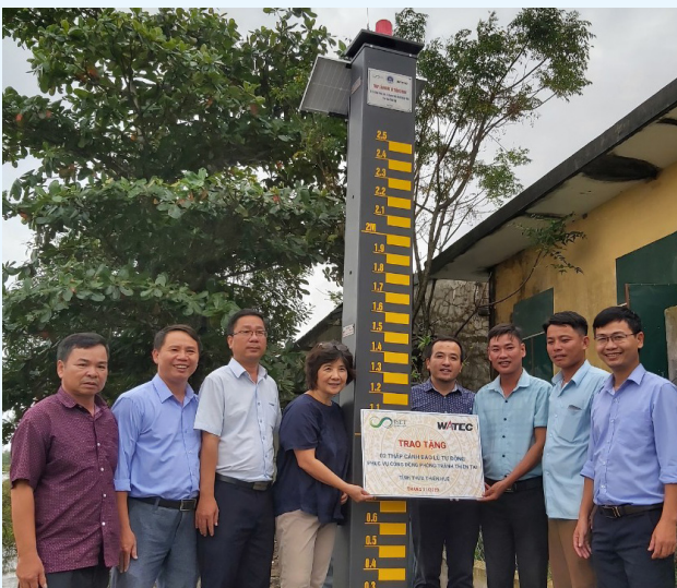
Tháp cảnh báo lũ thông minh do dự án FRMC và công ty Wateco hỗ trợ, lắp đặt tại xã Quảng Thái và xã Quảng Thọ, huyện Quảng Điền, tỉnh Thừa Thiên Huế. Thiết bị có thể đo độ sâu ngập, phát tín hiệu cảnh báo và kết nối tự động với hệ thống dữ liệu KTTV quốc gia. Tháp được trang bị tấm pin năng lượng mặt trời có thể hoạt động không cần nguồn điện trong vòng 30 ngày. Ảnh: BCH PCTT TTH
